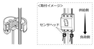
線径に合ったセンサヘッドを取り付けてください。線が細い場合(センサヘッド口径の約1/2以下)、電圧を検出できず電力測定できない場合があります。
