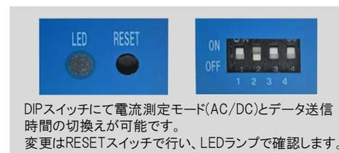
DIPスイッチにて電流測定モード(AC/DC)とデータ送信
