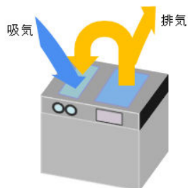
図3 排気が吸気に混じってしまう例
