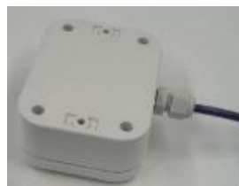
↑ケース裏側の 4 か所のビスを外します。
