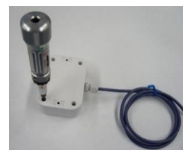
↑トルクレンチを使って ねじを締める。
