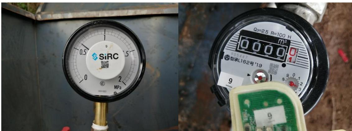
SIRC IoT 角度計測ユニット(PAK02)を後付けした圧力計。
