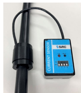
(電線取付けイメージ)
