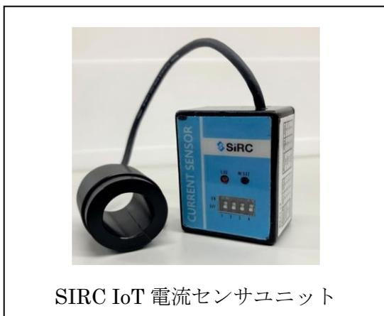
SIRC IoT 電流センサユニット
