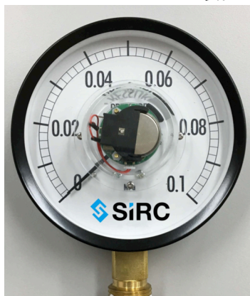
圧力計 IoT 装置 及び 表示画面
